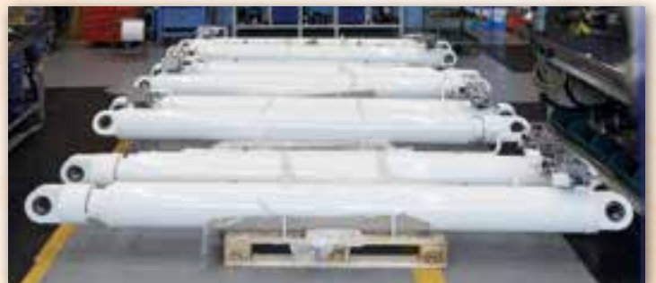
48 Hydraulikzylinder mit eingebautem Hydraulikblock und linearem Positionstransduktor, die bei Icop konstruiert wurden, werden nach Dubai geschickt, um dort die „Falkenflügel“ im Pavillon der VEA für die Expo 2020 zu steuern.
